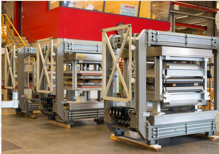
„Una ventaja importante de la prensa modular de doble banda es el cambio flexible de módulos sin quitar la banda. De esta manera, los procesos se pueden adaptar a los respectivos requisitos del producto cambiando los módulos de forma rápida y fácil. Adicionalmente, la instalación de elementos adicionales aumenta de forma significativa la capacidad de producción. Hay disponibles módulos de alfombra rodante, módulos de rodillos fijos, módulos de placa deslizante y módulos de satinado.“
